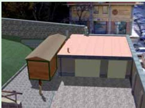
volume utile di cippato di circa 28 metri cubi. Il rifornimento dei due contenitori potrà avvenire direttamente dal tetto. Per l'estrazione del cippa-
